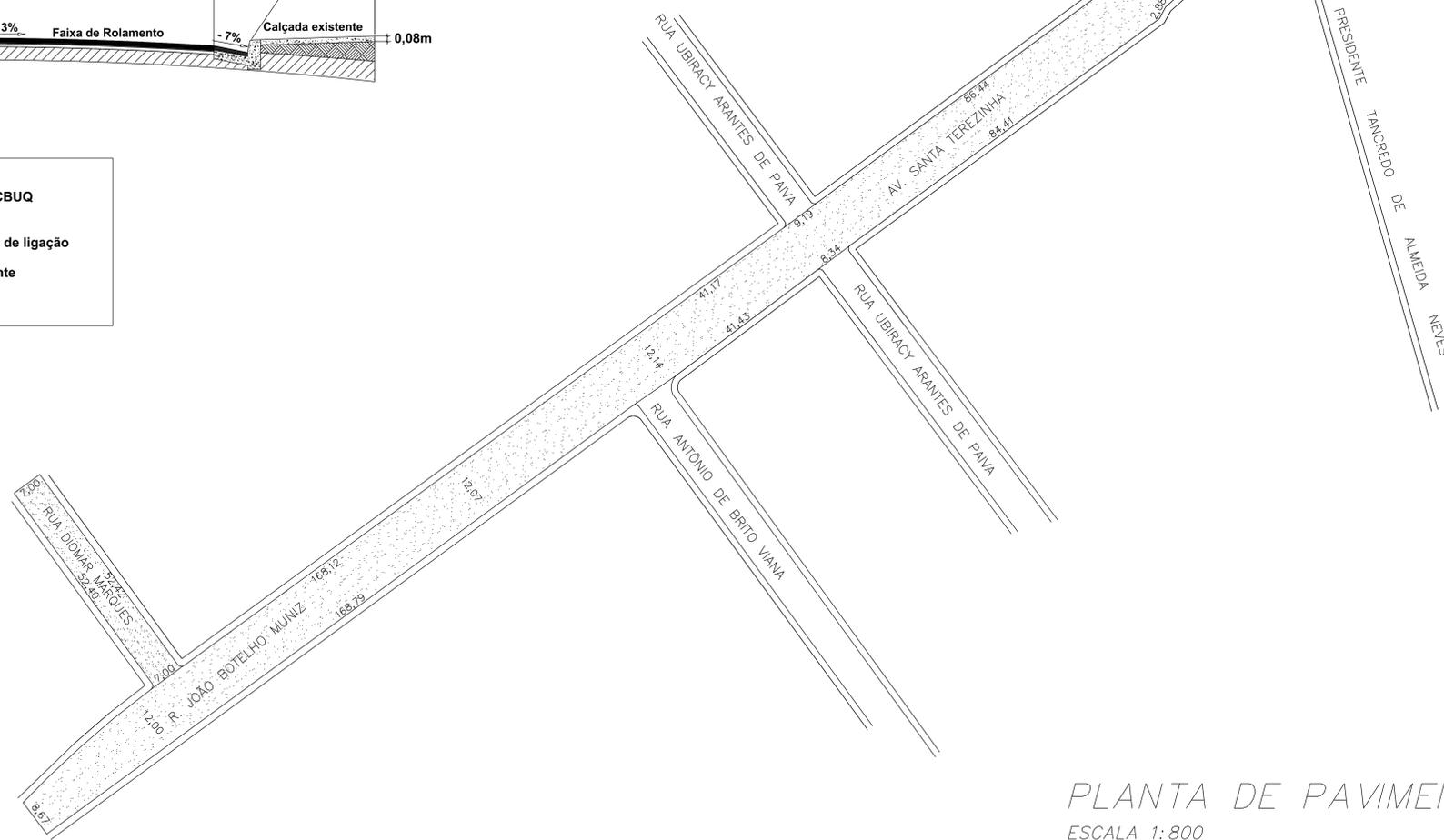
Recapeamento com CBUQ usinado a quente, cama de rolamento com espessura 3,00cm
